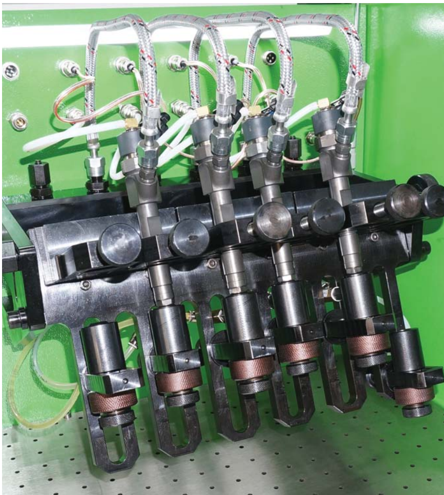
Фото 6. Универсальное шестиканальное крепление для инжекторов.
