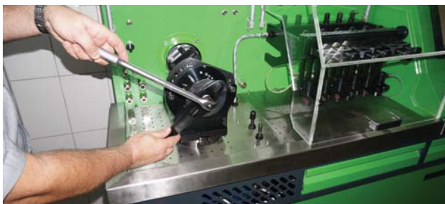
Фото 14. Благодаря вращающейся фланцевой стойке обеспечен легкий доступ к насосу.
