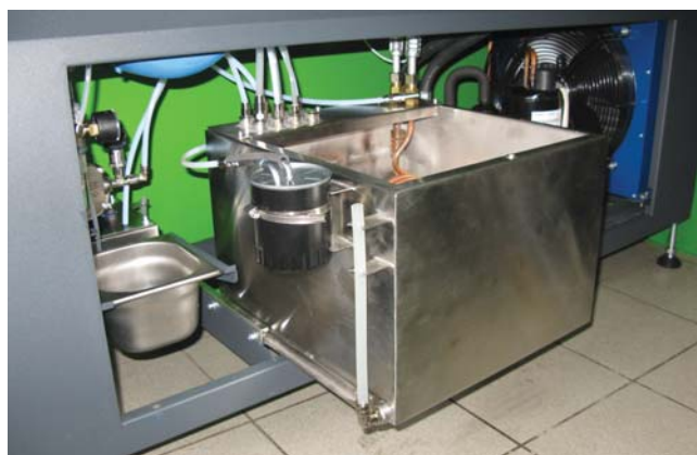
Фото 17. Бак выдвинут для мойки и замены фильтра.
