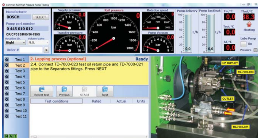
Фото 1. Обкатка насоса с фильтрами-отстойниками.
