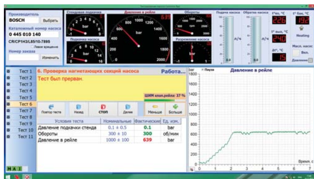
Фото 9. Проверка плунжеров – выявлена нестабильная работа одного из двух плунжеров.
