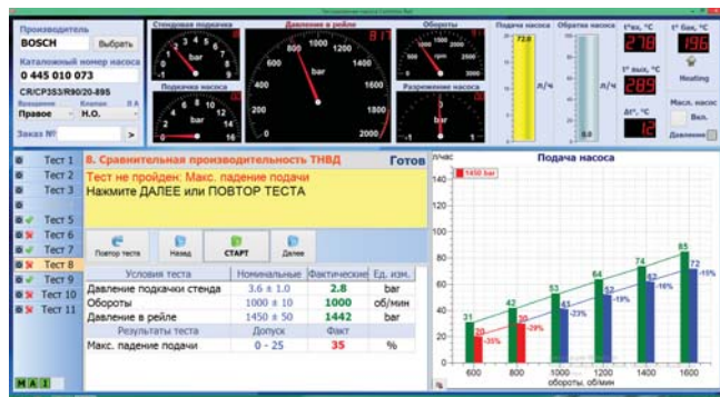
Фото 11. Проверка производительности – тест не пройден.
