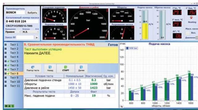
Фото 12. Проверка производительности – тест пройден.
